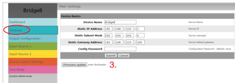
4. Tragen Sie die neue Firmware-Datei mit Hilfe des "Browse"-Knopfes ein und klicken Sie "upload", um den Aktualisierungsvorgang zu starten. Warten Sie bis der Vorgang beendet ist und der Normalbetrieb wieder aufgenommen wurde. Bestätigen Sie die Firmware-Version und das "Dashboard" des Geräts wird angezeigt.
